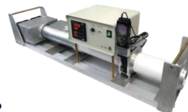
Автоматизированный стенд воздушного охлаждения
