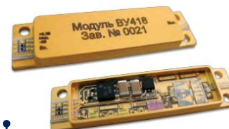
Серия универсальных усилителей средней мощности, перекрывающих диапазон 1-18 ГГц
