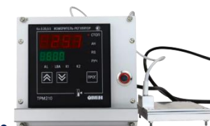
Одноканальная система задания положительной температуры объекта
