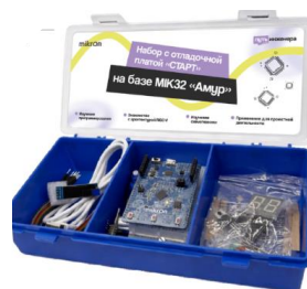
Набор «Старт» с отладочной платой на базе MIK32 Амур
