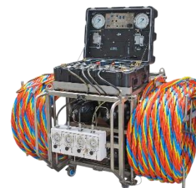
Станция обеспечения водолазных спусков ВСБР-4
