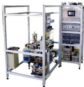
Лабораторная установка для нанесения покрытий с помощью газотранспортных реакций на экспериментальные образцы плоской формы
