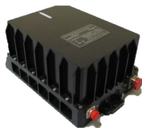
Бесплатформенная инерциальная навигационная система БИНС500К с встроенным приемником GPS/ГЛОНАСС
