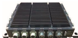
Защищенный промышленный компьютер с процессором Эльбрус-1С+
