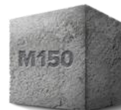
Тощий бетон на гравийном щебне M150
