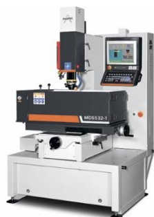
1-осевые копировально-прошивные станки с ЧПУ, с функцией «автотехнолог»
