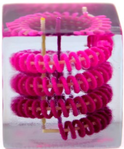
Винтовая спираль (наверху) и капиллярная сеть (внизу), напечатанные с помощью нового метода © CU Boulder
