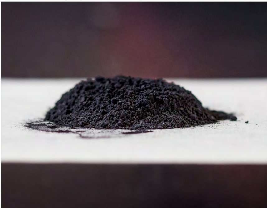
Порошок из переработанных катодов литий-ионных батарей
