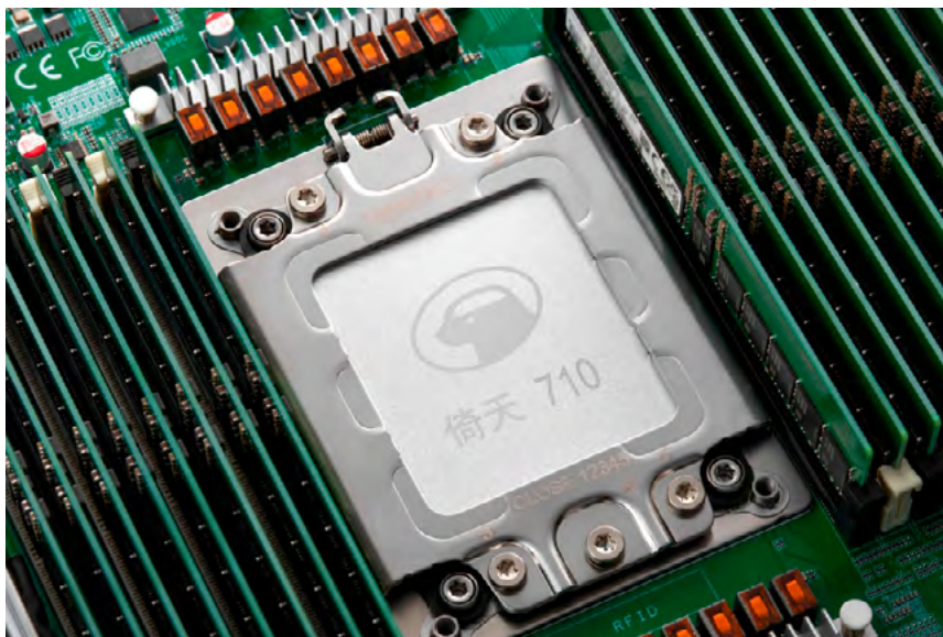
Серверный процессор Yitian 710 © Alibaba
