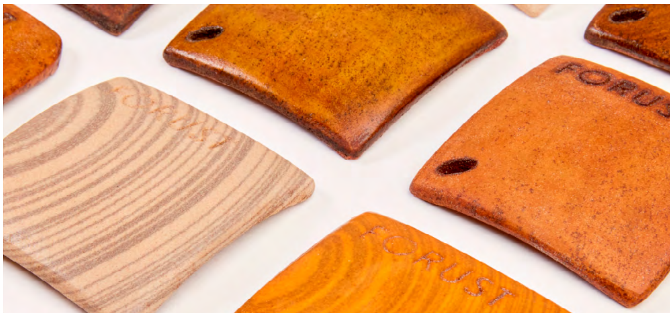
Образцы напечатанных материалов из древесных отходов © Forust
