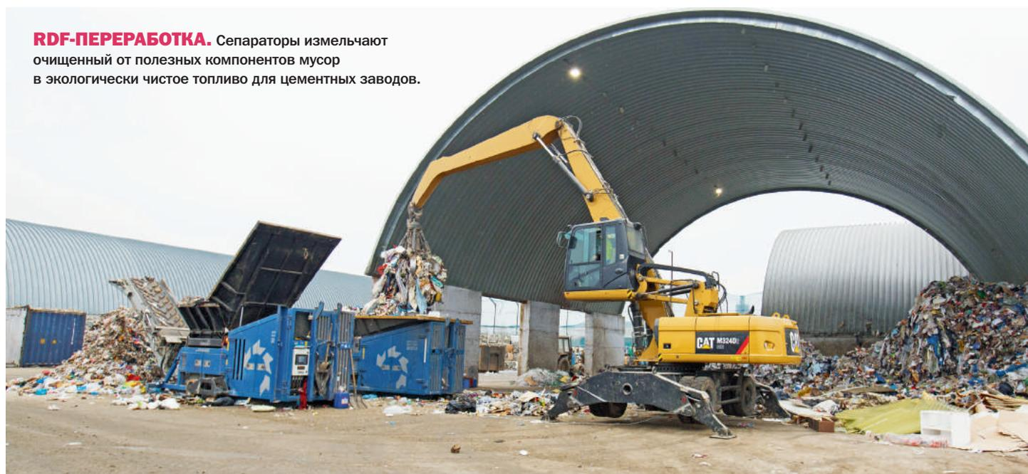
**RDF-ПЕРЕРАБОТКА.** Сепараторы измельчают очищенный от полезных компонентов мусор в экологически чистое топливо для цементных заводов.
